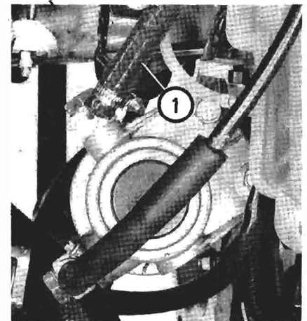
1) Stacco tubazione di alimentazione pompa iniezione
